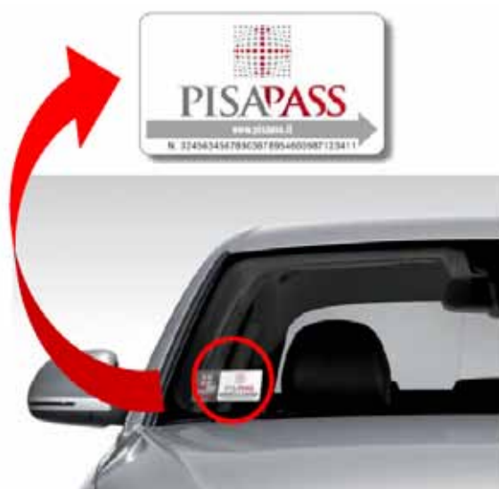
Figura 3.15 - Sistemi RFID per il tracking veicolare
